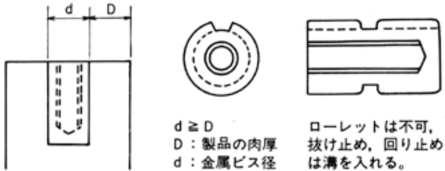
図 1 7 金属インサートの設計
