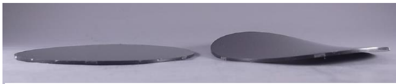
写真.円盤シートの反り比較(左：LX-530V、右：一般GF30%強化PBT)
